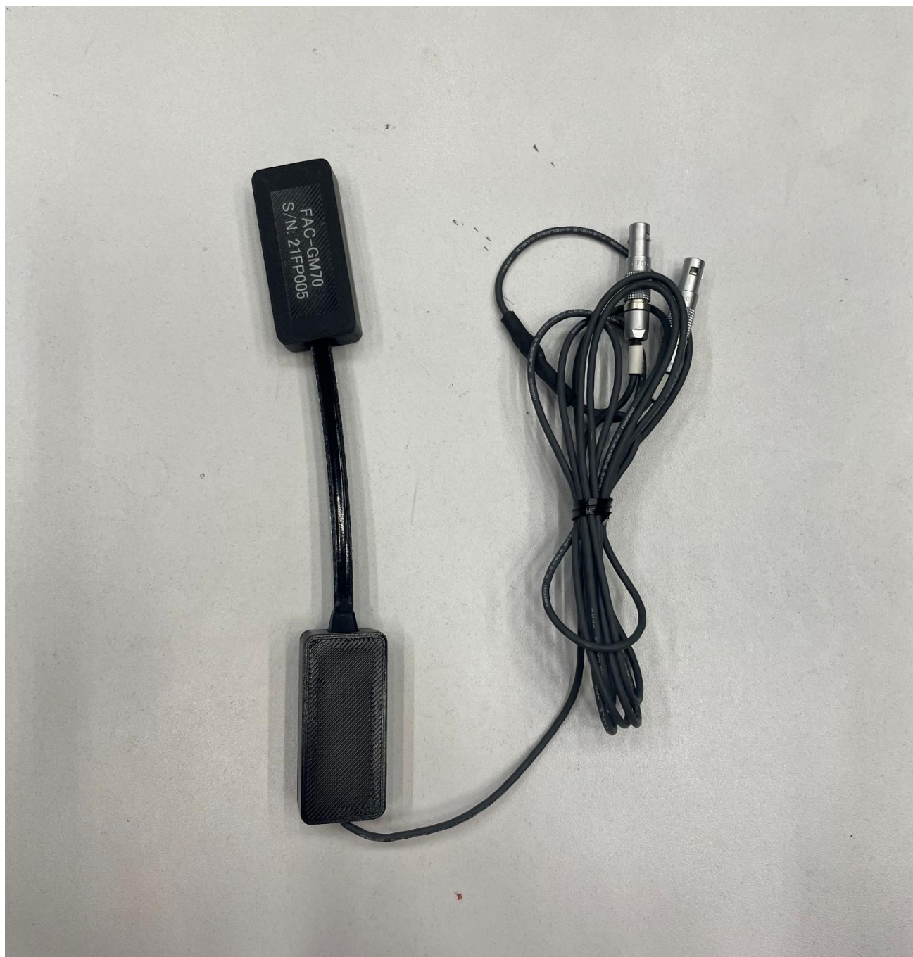
図 5 ゴニオセンサ股関節用（アクセルペダル変位の間接測定に使用）（株式会社フォーアシスト、東京、日本）
